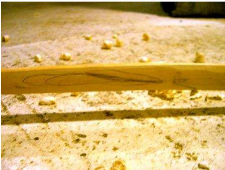
8eme étape. On marque au crayon les endroits où les branches ne plient pas assez, de façon à les identifier clairement lorsqu'il faudra raboter à nouveau.
