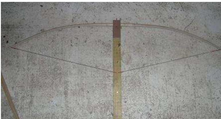
9eme à nieme étape. Sur ces 4 photos, l'arc a été recoupé à ses dimensions finales (1,80 m). Attention, lorsqu'on raccourci un arc, on augmente sa puissance. Ces étapes de tillering sont les plus longues et les plus
