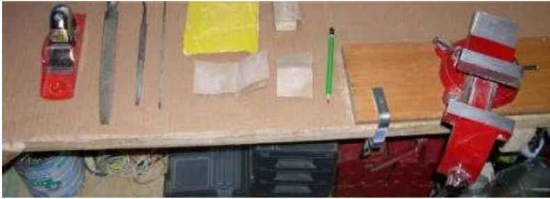
4eme étape. Voici les outils que j'ai utilisés pour fabriquer mon arc. De gauche à droite : un rabot (tout simple) pour enlever de la matière sur le ventre. Un double mètre. différentes limes : une râpe à bois, pour enlever la matière plus finement qu'avec le rabot, deux limes à métaux, pour tailler les encoches. du papier de verre de différents grains pour peaufiner le travail un crayon et un étau.
