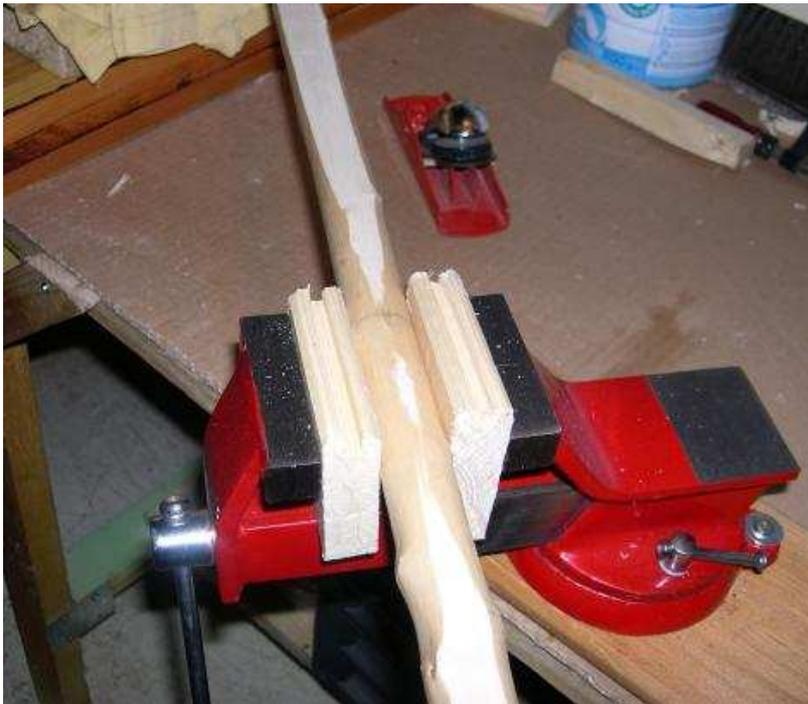
5eme étape. On fixe l'arc dans l'étau, ventre en l'air, et on attaque le rabotage, en ôtant peu de matière au centre de l'arc, et beaucoup aux extrémités.
